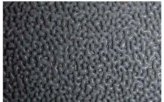
Bild: Oberfläche einer stochastisch gelaserten Filmwalze
